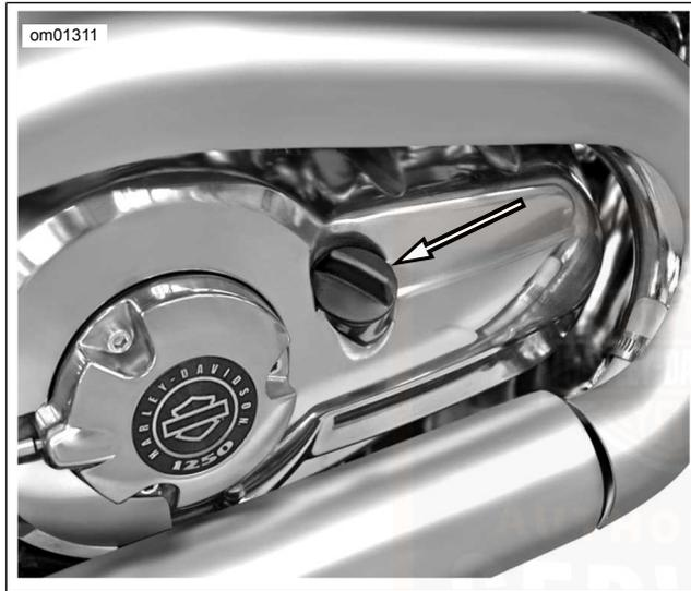
Abbildung 23. Lage des Ölmessstabs: VRSCF-Modell
