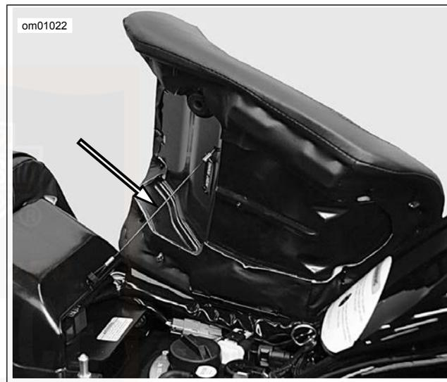
**Abbildung 65. Sicherungsleine des Sitzes: VRSC-Modelle**
