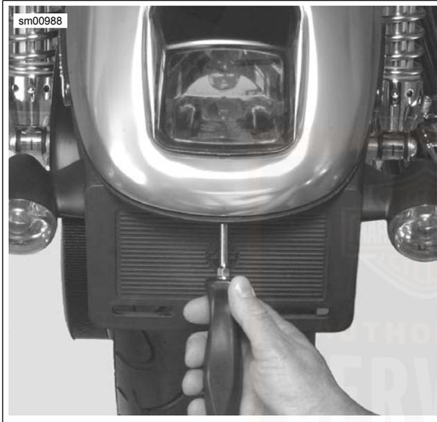
Abbildung 49. Schlussleuchtenhalteclip lösen (typisch)
