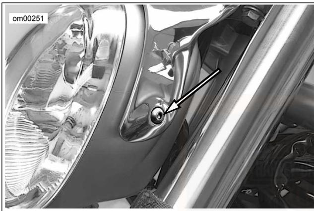
**Abbildung 46. Scheinwerferausrichtung, Befestigungsteil:
