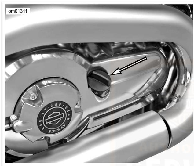
Abbildung 23. Lage des Ölmesstabs: VRSCF-Modell
