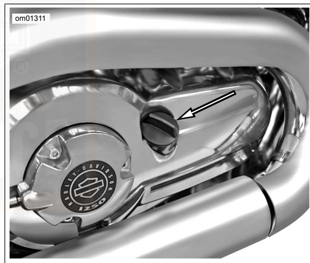
Abbildung 24. Lage des Ölmesstabs: VRSCF-Modell
