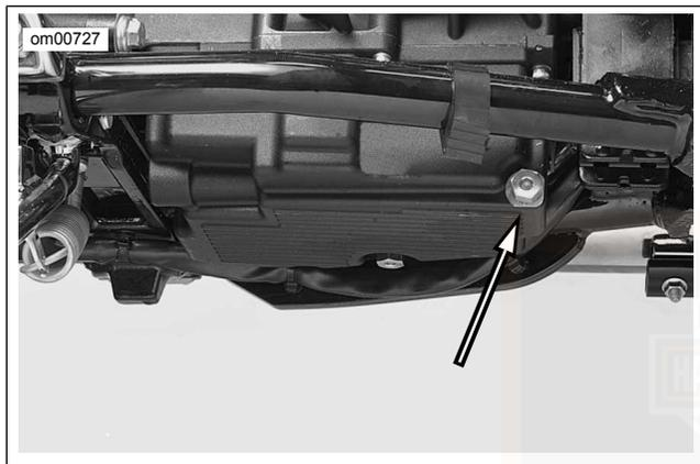
**Abbildung 41. Motorölablassschraube (links unter dem Getriebe)**
