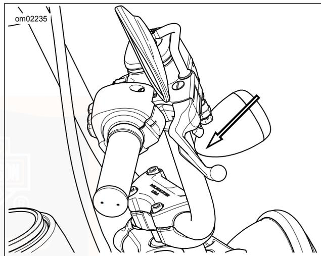
Abbildung 23. Vorderradbremshebel
