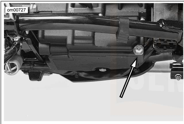
Abbildung 23. Motorölablassschraube (Ölwanne unter dem Getriebe, Ansicht der linken Fahrzeugseite)
