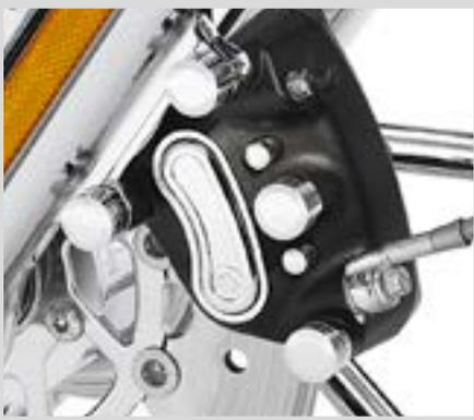
**I. CUSTOM-BOLZENABDECKUNGEN FÜR BREMSSATTEL – (40955-05 ABGEBILDET)**
