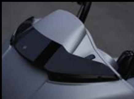
Farblich abgestimmte Innenverkleidung und Luftkanal..... S. 761
