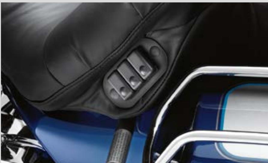
**B. ROAD ZEPPELIN SITZ MIT EINSTELLBAREN LUFTPOLSTERN – BEDIENTAFEL**
