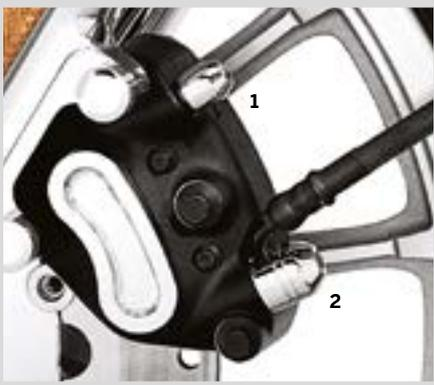
**J. ABDECKUNGEN FÜR ENTLÜFTUNGSSCHRAUBE UND HOHLSCHRAUBE**
