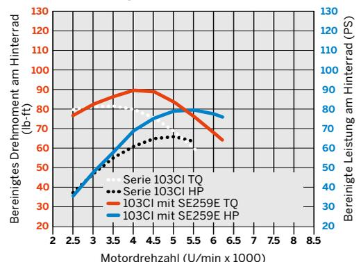
Twin Cam H0103CI Serie im Vergleich zu 103CI Stage II mit SE-585 Nockenwelle
