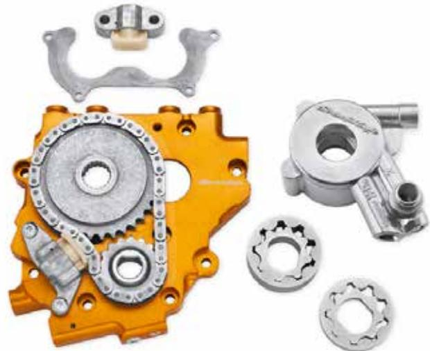
B. SCREAMIN' EAGLE UPGRADE-KIT AUF HYDRAULISCHEN STEUERKETTENSPELLER UND HIGH FLOW ÖLPUMPE
