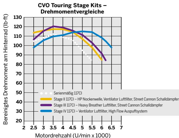
DYNAMOMETER (DYNO)-LEISTUNGSTESTS: Die in diesem Katalog angegebenen Leistungswerte entsprechen der Spitzenleistung gemäß SAE J-1349. Dynamometereinstellungen, Motorradzustand, Schwankungen, Klima und andere Faktoren können die Leistungsergebnisse beeinträchtigen.
