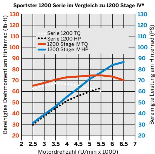
\* 1200 Stage IV mit High Flow Luftfilter und Street Cannon Schalldämpfern
