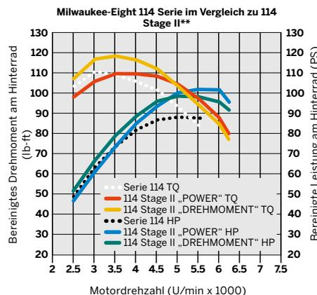
\* FLHX 107 Stage II POWER mit Ventilator Luftfilter und Street Cannon Schalldämpfer
