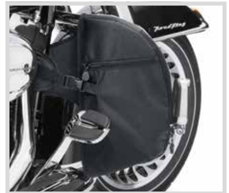
D. SPRITZSCHUTZ - RÜCKANSICHT
