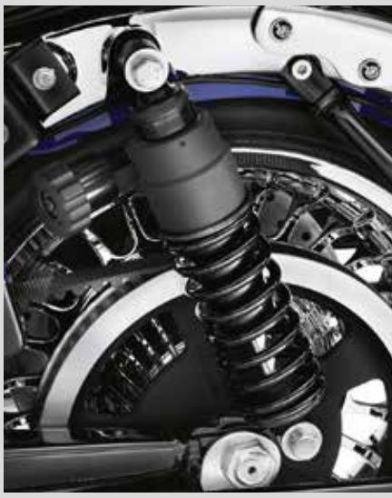
F. VERSTELLBARE PREMIUM RIDE TOURING STOSSDÄMPFER
