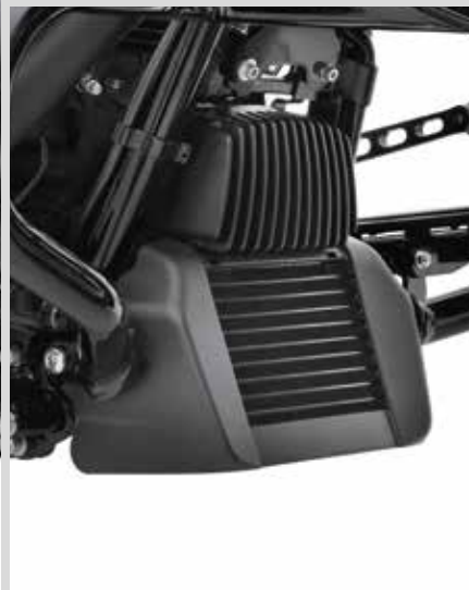
B. ÖLKÜHLER MIT LÜFTERUNTERSTÜTZUNG
